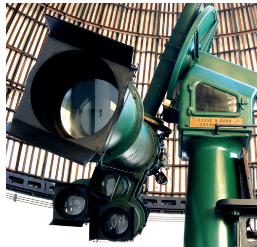
Detalhe do conjunto de lentes da Grande Luneta Equatorial de 46cm
